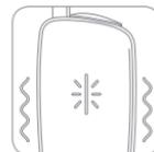
Dois flashes da luz de LED completos e duas vibrações indicarão que o dispositivo está bloqueado.
