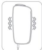
A vibração indica que foi ligado um cabo de carregamento USB ao dispositivo.
