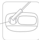
Durante a limpeza, preste especial atenção às duas partes salientes 15 mm abaixo do bordo superior do aquecedor.
